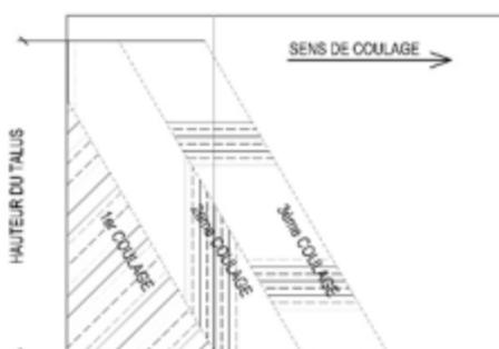
Figure 46 : Principe du coulage « en talus »
